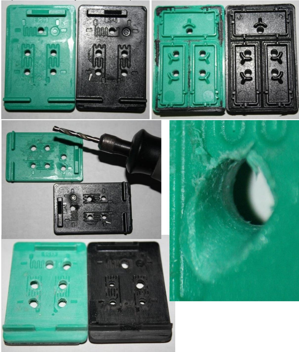
*Detalles de la tapa de los cartuchos y rebaje en orificios*
